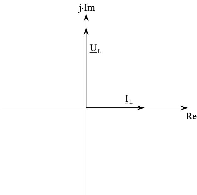
Die Gleichung im Zeigerdiagramm für den Strom  $\underline{I}_L$  lautet:  $\underline{I}_L = \hat{i}_L \cdot e^{j\omega t}$ , für die Spannung  $\underline{U}_L$ :  $\underline{U}_L = \hat{u}_L \cdot e^{j(\omega t + 90^\circ)}$ . Im Zeigerdiagramm sieht man ganz deutlich, dass die Spannung dem Strom um  $90^\circ$  voreilt.
