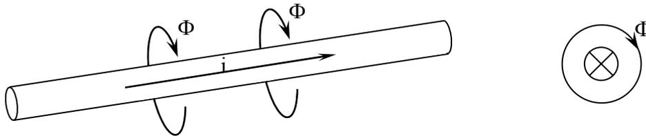
Wickelt man diesen Leiter zu einer Leiterschleife, so erhält man eine Induktivität (Spule). Diese ist – genau wie die Kapazität – ein Energiespeicher. Sobald sie vom Strom durchflossen wird, baut sie ein Magnetfeld auf. Reißt der Stromfluss ab, dann sorgt die gespeicherte Energie im Magnetfeld dafür, dass der Stromfluss in die gleiche Richtung für eine gewisse Zeit erhalten bleibt. Die Induktivität dient damit praktisch als Quelle.
