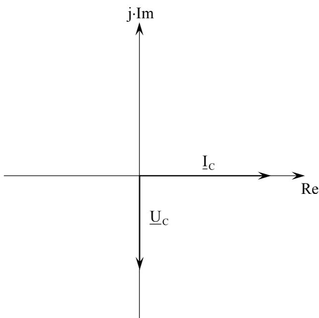
Die Gleichung im Zeigerdiagramm für den Strom  $\underline{I}_C$  lautet:  $\underline{I}_C = \hat{i}_C \cdot e^{j\omega t}$ , für die Spannung  $\underline{U}_C$ :  $\underline{U}_C = \hat{u}_C \cdot e^{j(\omega t - 90^\circ)}$ . Im Zeigerdiagramm sieht man ganz deutlich, dass die Spannung dem Strom um  $90^\circ$  nacheilt.
