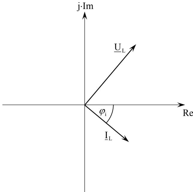
Das gleiche Ergebnis – also ein Voreilen der Spannung  $\underline{U}_L$  zum Strom  $\underline{I}_L$  um  $90^\circ$  – erhält man ebenfalls, wenn der Strom eine beliebige Phasenverschiebung  $\varphi_1$  zum Zeitpunkt  $t = 0$  besitzt (hier im linken Zeigerdiagramm ist  $\varphi_1 < 0$ ):  $\underline{I}_L = \hat{i}_L \cdot e^{j(\omega t + \varphi_1)} = \hat{i}_L \cdot e^{j\varphi_1} \cdot e^{j\omega t}$
