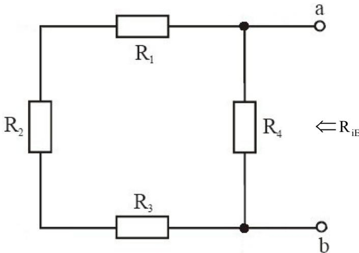
Die Widerstände  $R_1$ ,  $R_2$  und  $R_3$  liegen in Reihe; alle zusammen parallel zu  $R_4$ . Als Ergebnis erhält man für  $R_{iE}$ :
