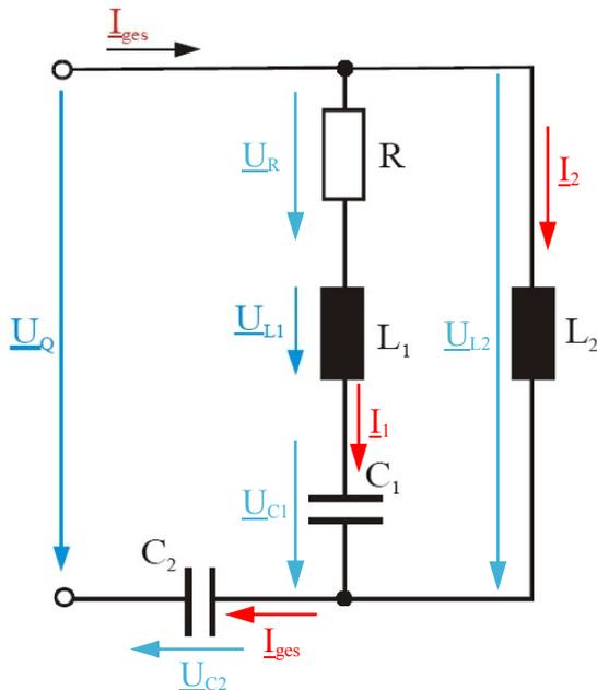
Der Betrag der Spannung  $\underline{U}_{L1}$  beträgt 20V. Daraus lässt sich der Strom  $\underline{I}_1$  in dem linken Strang berechnen. Weiterhin lassen sich mit diesem Strom die Spannungen an  $R_1$  und  $C_1$  bestimmen.
