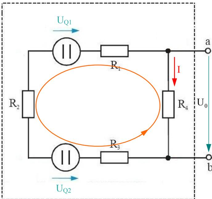
Die Widerstände  $R_1$  und  $R_3$  sind die jeweiligen Innenwiderstände der Stromquellen. Aus ihnen werden die Innenwiderstände der Ersatzspannungsquellen  $U_{Q1}$  und  $U_{Q2}$ . Damit liegen alle vier Widerstände in Reihe, denn sie werden von dem Strom  $I$  durchflossen. Die Richtung dieses Stromes erfolgt willkürlich, denn:
